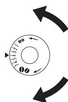
*Поверните регулятор против часовой стрелки, чтобы получить кофе более тонкого помола, меньшую скорость розлива и большее количество пены.*
